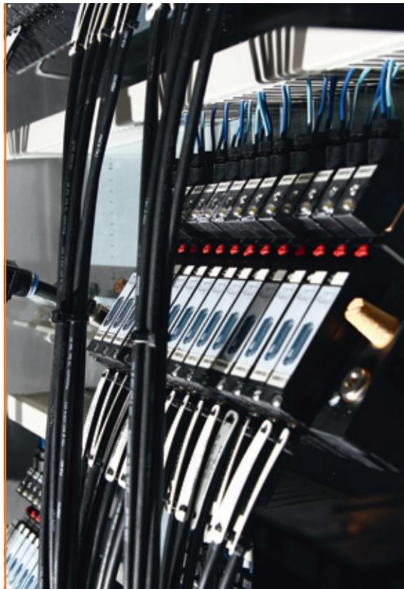
*Ventil-Insel zur Ansteuerung pneumatischer Ventile*
